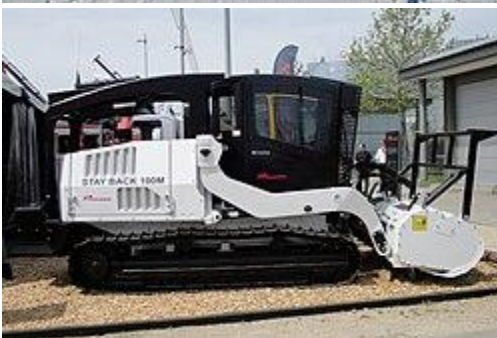
Il modello Beaver, un cingolato per la deforestazione
